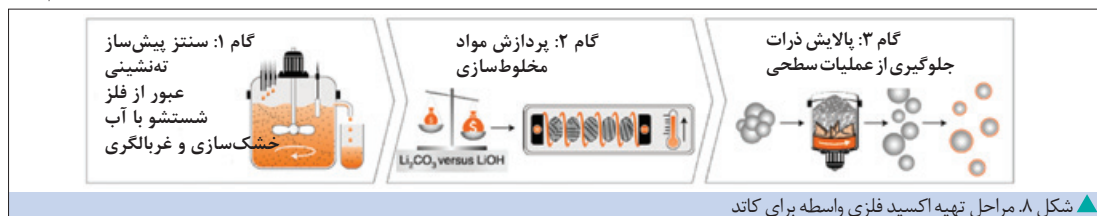
شکل ۸. مراحل تهیه اکسید فلزی واسطه برای کاتد
